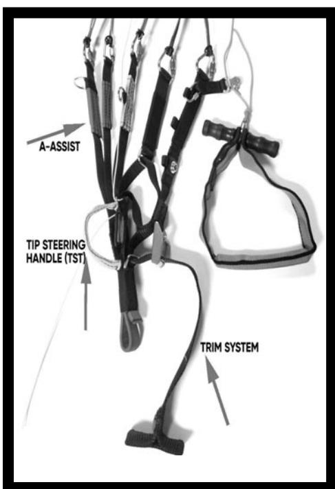
Nous avons conçu des élévateurs spéciaux pour apporter des solutions aux différents problèmes rencontrés avec un système standard en vol motorisé. Les matériaux les plus robustes sont utilisés, en particulier au niveau des points de fixation. La sangle des trims est équipée de coutures de sécurité et de repaires de couleur afin de visualiser facilement leur position en vol.
