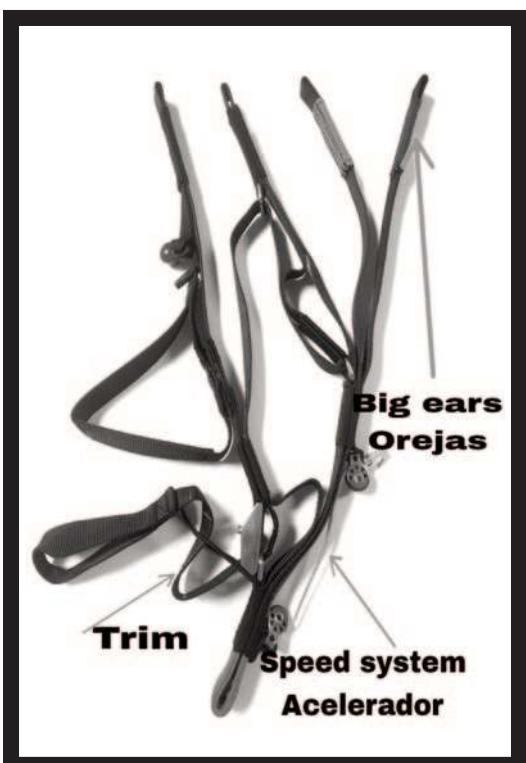
La élévateur A est déplié en deux, pour faciliter la réalisation des «oreilles».
