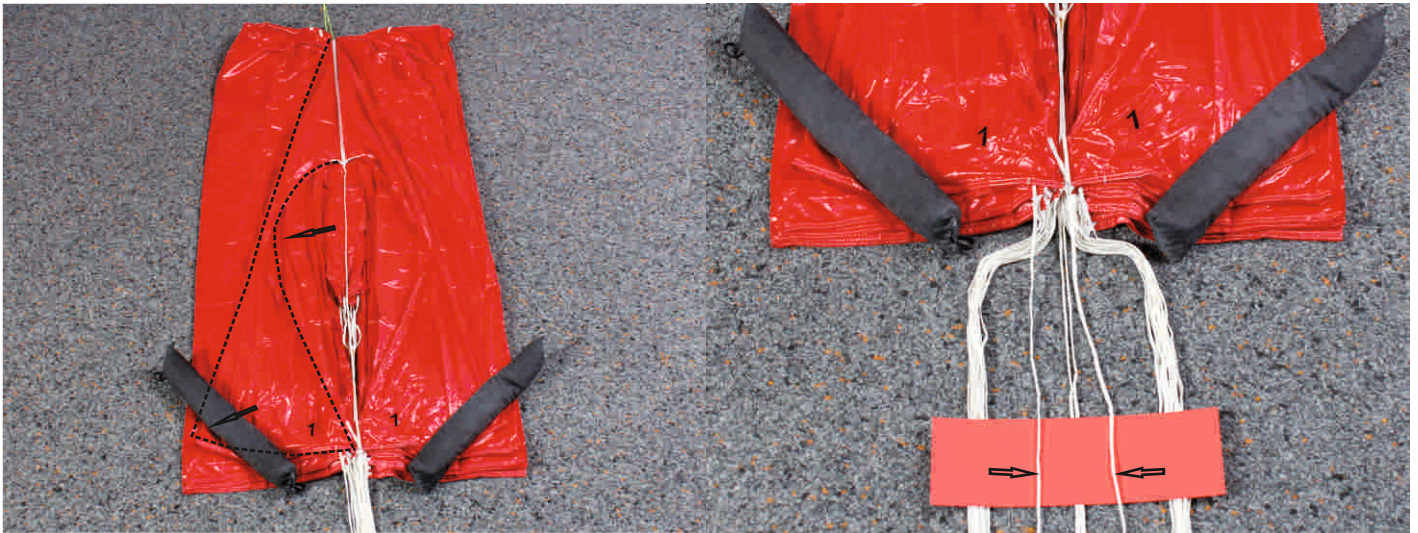
15. Bahn 1 legen. (Eckbahn) und Basis mit Gewicht beschweren.
