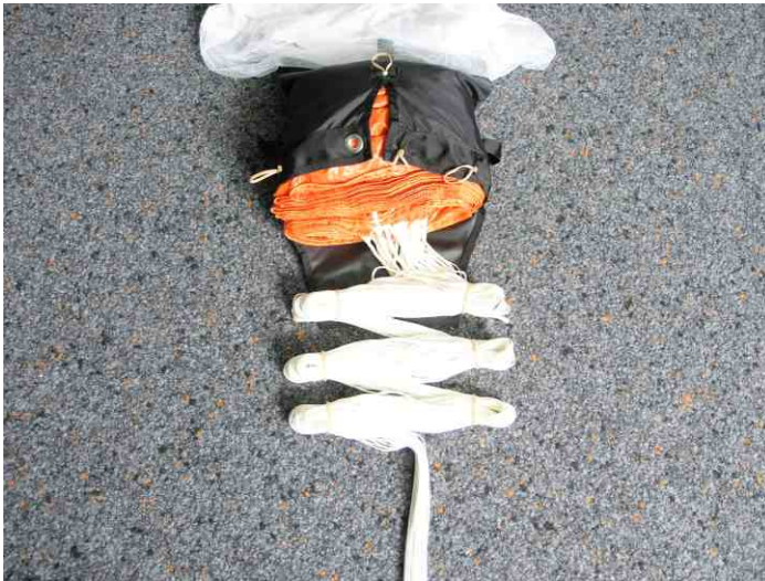
13. Fangleinen in 3x3 Achterschlägen bündeln. Die letzten ca 60 cm Fangleinen nicht bündeln.
