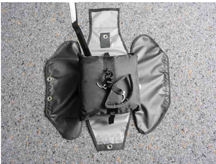
1. Auslösegriff in der mittleren Schlaufe des Innencontainers einschlaufen. Verbindungsleine an der gewünschten Seite aus dem Außencontainer herauslaufen lassen. Hinweis: die Tandemversionen besitzen eine als "V" ausgeführte Verbindungsleine! (Dieses Bild zeigt einen Innencontainer ohne Hilfsschirm)
