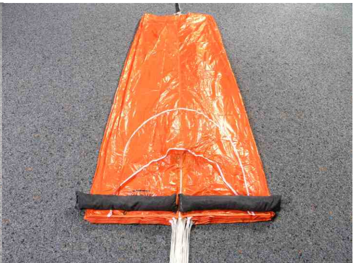
6. Wenn alle Bahnen sauber gelegt sind beidseitig mit Packgewicht beschweren.
