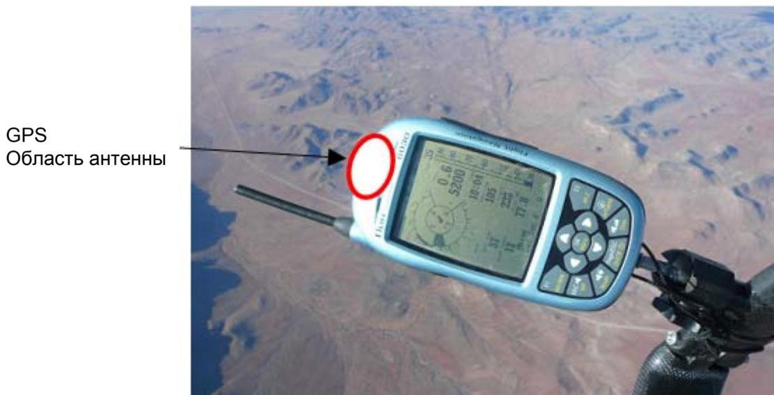
Поскольку сила получаемого от спутника сигнала составляет приблизительно лишь 1/1000 от сигнала мобильной рации, такие радиоприборы и другие побочные факторы (например, ноутбуки) должны использоваться на столько далеко от Comreo+, на сколько возможно.
