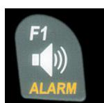
Кнопкой **Audio level** можно выставить требуемый уровень громкости. Возможно установить пять уровней громкости от молчания до максимума. Выбранный уровень отражается рядом с символом на дисплее и дублируется звуковым сигналом при нажатии на кнопку. Выставление уровня громкости идет путем нажатия на кнопку **Audio level** в сторону увеличения с шагом 25%:
