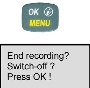
1. Если функция записи полета не активирована, то выключение прибора произойдет незамедлительно за нажатием **OK**.
