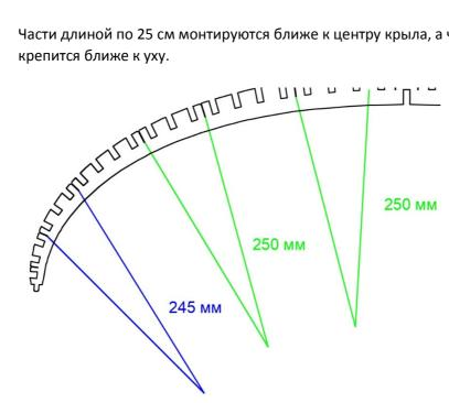
Для второй половины крыла следует нарезать точно такие же отрезки и навязать там узлы. После этого их можно установить на каркас крыла также, как и для первой половины.
