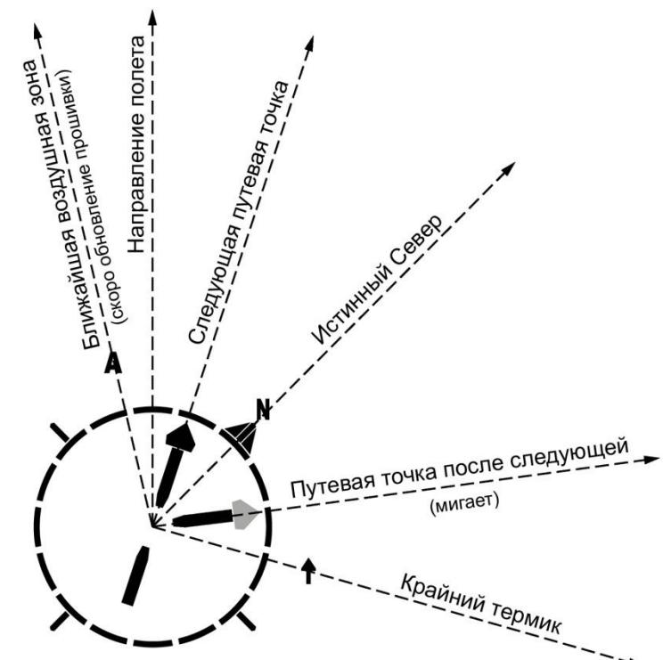
В полете Flytec Element будет показывать направление к вашей следующей путевой точке в виде стрелки на розе компаса. Для полета к следующей путевой точке вашего маршрута поворачивайте парашют, пока острье стрелки не окажется вверху розы компаса.
