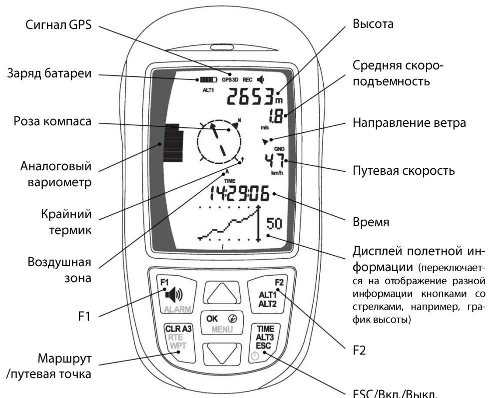
**ALT 1** выдает вашу высоту над уровнем моря. Она автоматически калибруется по спутникам GPS.
