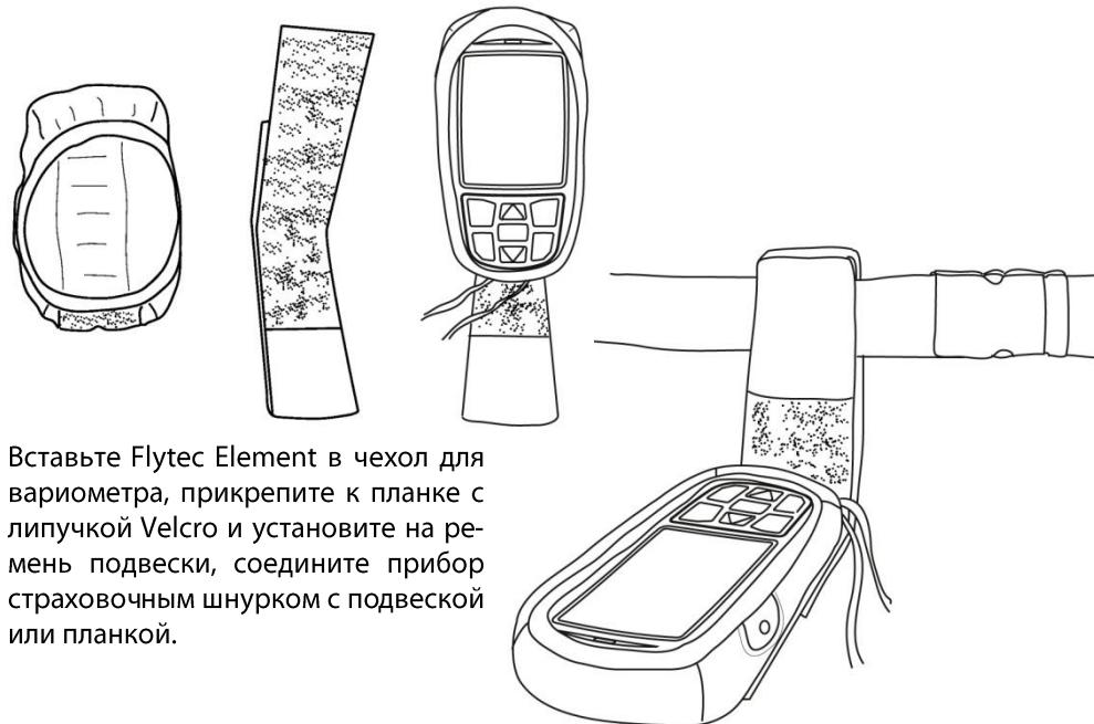
Вставьте Flytec Element в чехол для вариометра, прикрепите к планке с липучкой Velcro и установите на ремень подвески, соедините прибор страховочным шнурком с подвеской или планкой.
