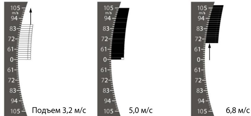
Средняя скороподъемность выдает вашу вертикальную скорость, усредненную в течение крайних пяти секунд.
