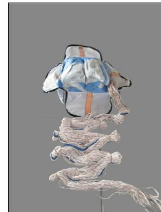
Rabattez les volets du pod sur l'ensemble du paquet et passez l'élastique servant à verrouiller le pod au travers de l'oeillet.
