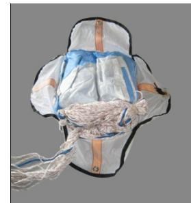
Verrouillez maintenant le pod en passant une boucle des suspentes se trouvant hors du pod dans l'élastique de fermeture. Lorsque le pod est jeté, les suspentes arrivant en tension vont se libérer de l'élastique, permettant l'ouverture du pod et la libération du parachute de secours.
