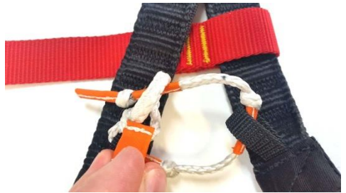
Leinenende durch die Leinenschleufe führen
