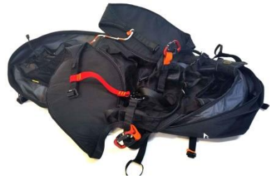
Das Gurtzeug aus dem Rückenstaufach ziehen
