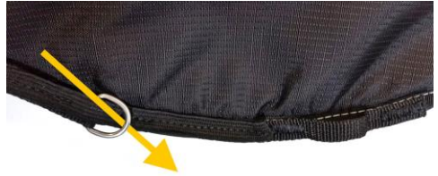
Montagerichtung der Beschleunigerleine an den Beinschlaufen
