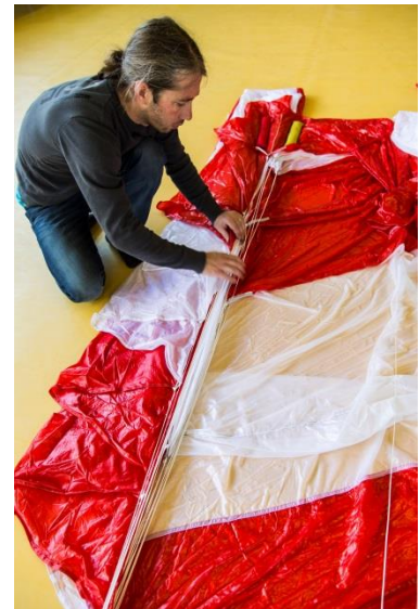
Pic. 78-79 Glissez l'excès de tissus dans les panneaux pliés
