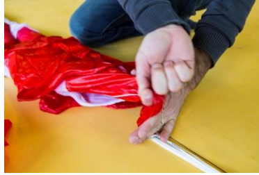
Pic. 112-115 Sécurisez l'ensemble au bord de fuite avec un élastique
