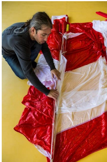
Pic. 78-79 Glissez l'excès de tissus dans les panneaux pliés
