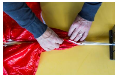
Pic. 88-89 Enroulez les tissus autour des suspentes
