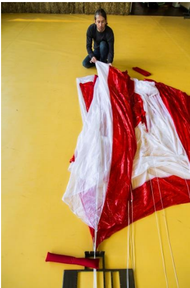
Pic. 68 Suspente du panneau #3 dans le séparateur
