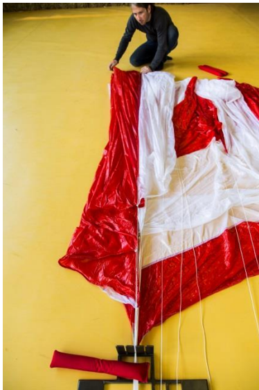
Pic. 74 Suspente dans le séparateur
