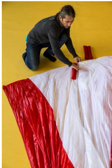
Pic. 57 Couture sur la suspente centrale
