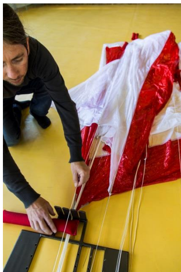
Pic. 63 Mettez la suspente du panneau #2 dans le séparateur
