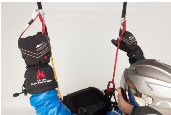
Pic1. Attachement aux maillons principaux
