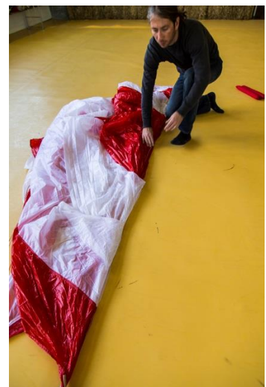
Pic. 80-82 Retournez la deuxième partie du parachute par-dessus le séparateur sur la partie déjà pliée
