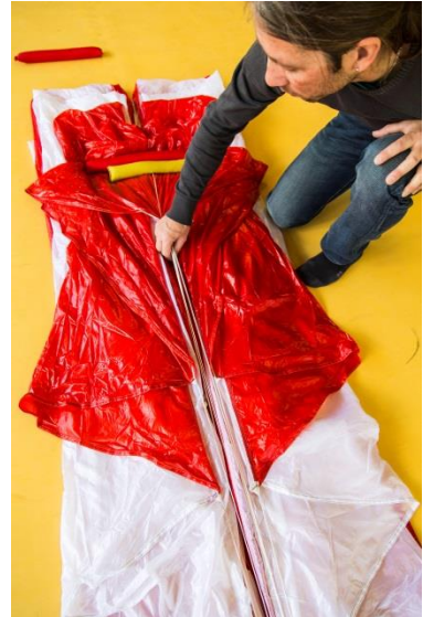
Pic. 85 Vérifiez que les suspentes soient bien claires ...
