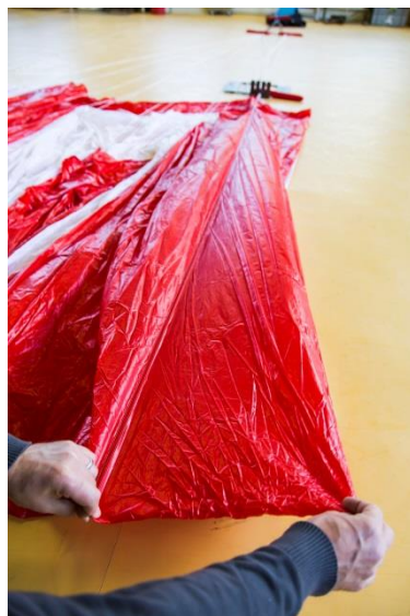
Pic. 72 Posez le panneau #4 à l'extérieur et pliez le en 2
