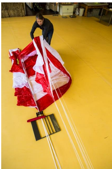
Pic. 80-82 Retournez la deuxième partie du parachute par-dessus le séparateur sur la partie déjà pliée
