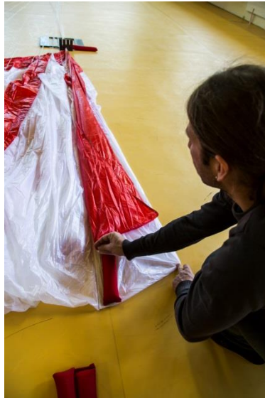
Pic. 59/60 ...un pliage en S (seulement en 2 pour l'Ultra Light 100)
