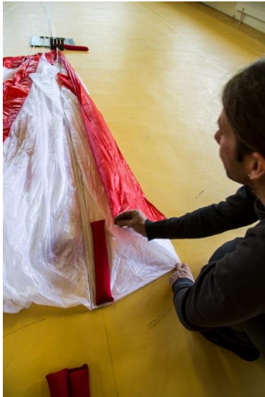
Pic. 59/60 ...un pliage en S (seulement en 2 pour l'Ultra Light 100)
