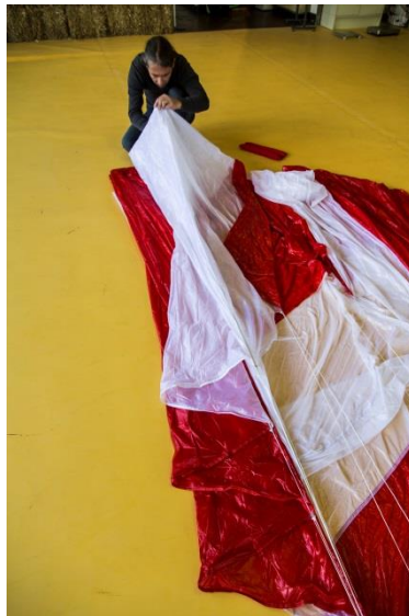
Pic. 75-77 Pliez les panneaux restants jusqu'au nez...
