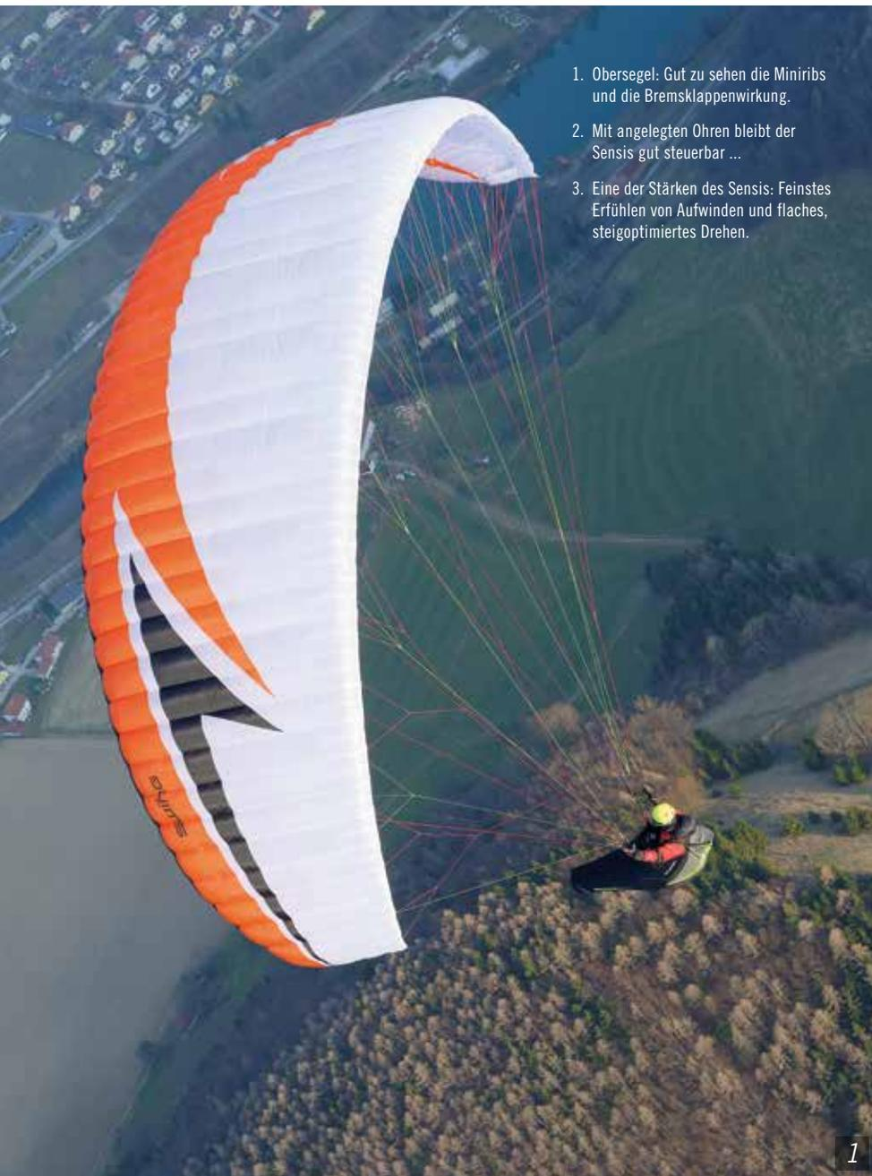
1. Obersegel: Gut zu sehen die Miniribs und die Bremsklappenwirkung.
