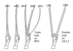
Werksauslieferung mit doppeltem Loop der C-Stammleinen für die Trimmung bei Alterung
